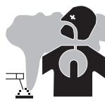
Beim Schweißen entstehen Rauchgase bzw. toxische Dämpfe, die zu Sauerstoffmangel in der Atemluft führen können. Sorgen Sie daher immer für ausreichend Frischluft, technische Belüftung (oder ein zugelassenes Atmungsgerät). Verwenden Sie die Schneidanlagen nur in gut belüfteten Hallen, im Freien oder in geschlossenen Räumen mit ausreichend starker Absaugung, die den aktuellen Sicherheitsstandards entspricht.
