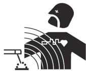
La corriente eléctrica causa campos electromagnéticos (EMF) al atravesar un conductor. Los soldadores deben seguir las instrucciones siguientes para reducir al mínimo la exposición a los campos electromagnéticos del circuito de soldadura:
