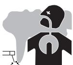
I fumi, gas e polveri emessi dalla saldatura sono pericolosi per la salute. È necessario prevedere una ventilazione sufficiente e a volte è necessario un apporto d'aria. Una maschera ventilata ad aria fresca potrebbe essere una soluzione in caso di aerazione insufficiente.
